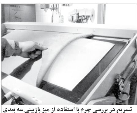
قالب‌گیری از یک طرف کش آمده باشد خوب روی قالب نمی‌نشیند. اگر اجزاء رویه را از بخش‌های دارای سطح نایکنواخت برش دهیم یا اگر خیز چرم در آن بخش زمخت‌تر باشد این ایرادها در کفشهای نهایی بازتاب می‌یابد و به فروش نمی‌رود. خرده فروش‌ها هم فوری مخصوصات کم‌فروش و کم کیفیت را تشخیص می‌دهند.
